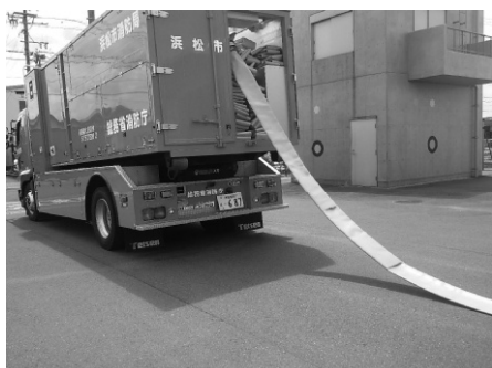
(写真7) 従来通りの手作業での残水処理 (労力負担が非常に大きい)
